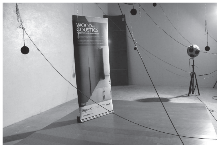
Labo testopstelling - EN ISO 354:2003
